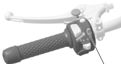
Segnalazione di emergenza (Hazard)
